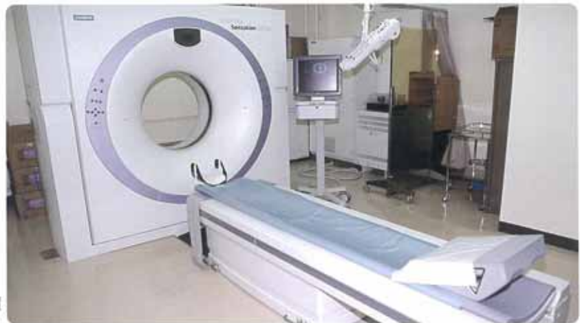
コンピュータ断層撮影装置 (16列マルチスライスCT)
